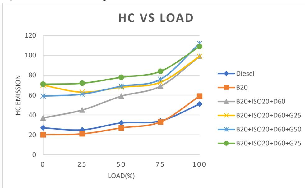
Fig 8. HC vs load
